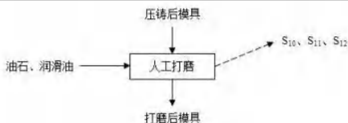
图 2-3 模具修模流程及产污环节图
